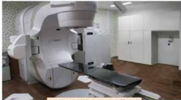
4・6・10MV X線、6・15MeV 電子線 0.5, 1cm幅マルチリーフ・コリメータ
